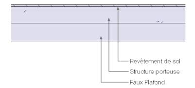
Figure 14 - Création d'un plancher entre étages
