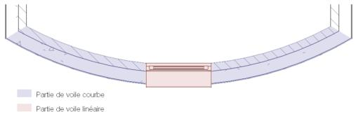
Figure 21 - Surface vitrée placée dans un voile courbe
