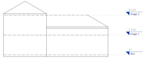
Figure 16 - Toitures à différents niveaux
