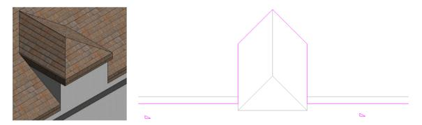
Figure 18 - Chien assis avec murs de fermeture de dénivelé en bordure de toiture
