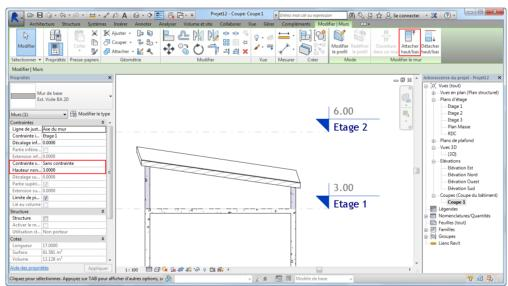
Figure 9 - Attacher un mur
